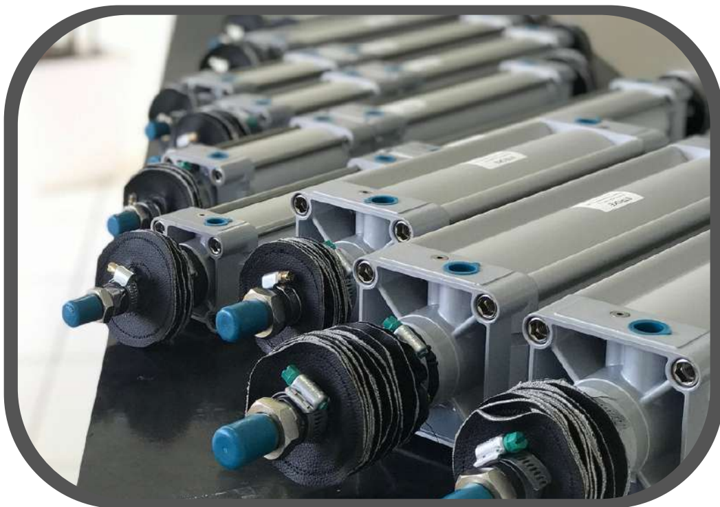
Cilindros reformados e adicionadas as sanfonas de proteção.
