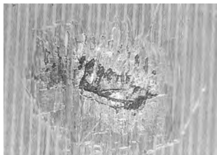
Fadiga de superfície em mancal de rolamento
